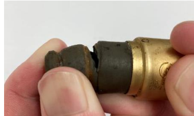
ガス栓用プラグ（ガストーブ）亀裂
