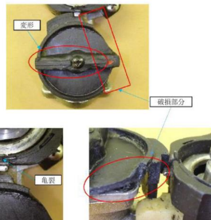
ガス栓の変形部分
