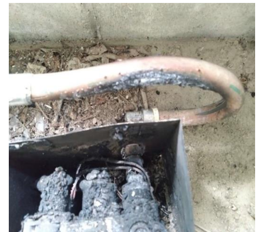
メカ部（ガバナ及びソレノイドバルブ部分）、強化ホースの焼損
