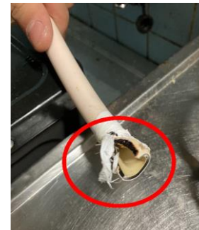
ソフトコード亀裂及び焼損状況
