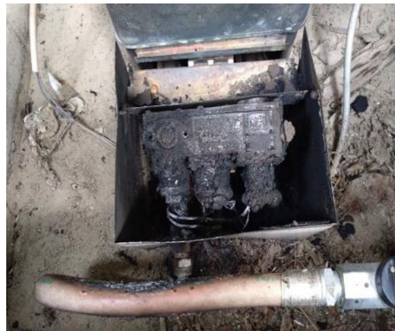
メカ部（ガバナ及びソレノイドバルブ部分）、強化ホースの焼損
