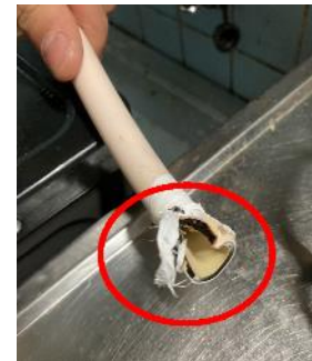
ソフトコード亀裂及び焼損状況
