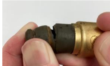
ガス栓用プラグ（ガストーブ）亀裂
