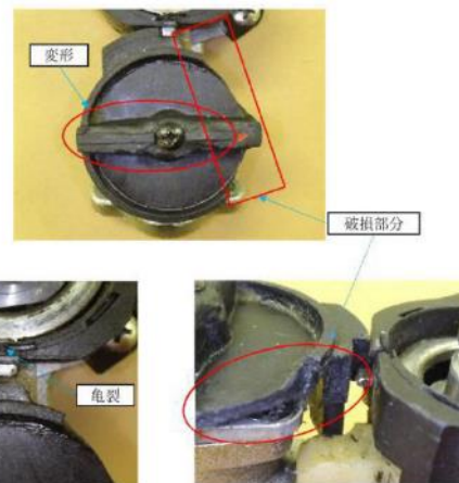
ガス栓の変形部分
