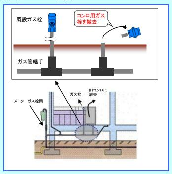
一般家庭において、ガスコンロからIHコンロへの取替え時に、ガス事業者に無断でコンロ用ガス栓が撤去された事例が発生しました。
