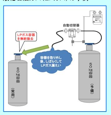
一般家庭において、オール電化工事の基礎工事中に、施工業者が、保安上の措置を行わぬままLPガス容器を取り外した結果、LPガスが大量に漏えいする事故が発生しました。
