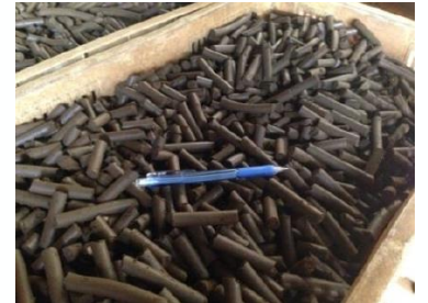
製造直後の脱硫化水素剤
