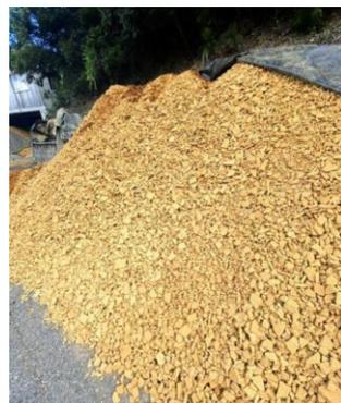
坑廃水の処理工程で発生する「中和殿物」
