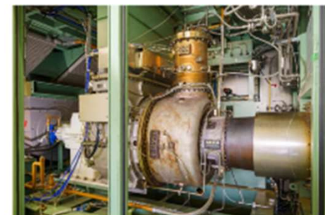
液体アンモニアと天然ガスを混焼した 2,000kW級ガスタービン (当社 横浜事業所内)
