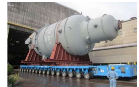
大型リアクタ (Shell & Tube) 最大実績容量 275kt/y (EO)
