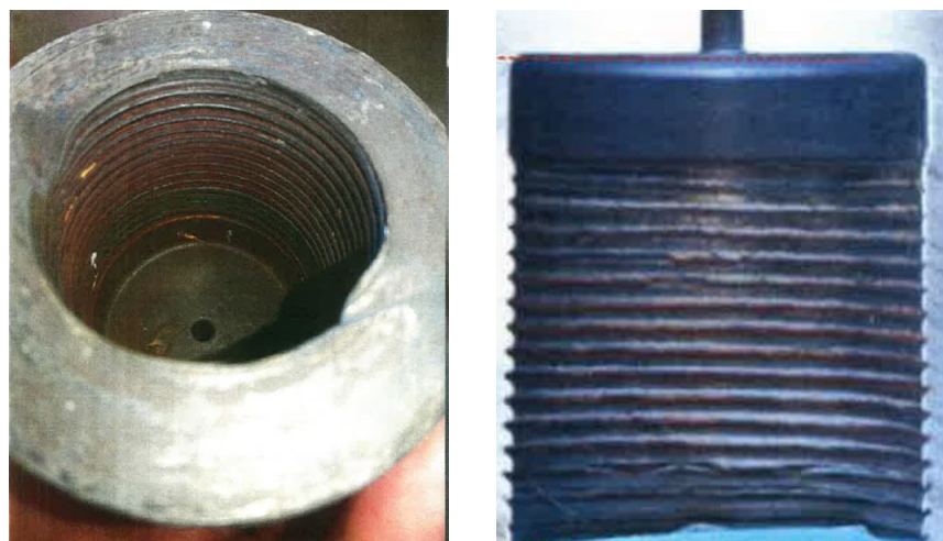
図7 ナットねじ破損例
