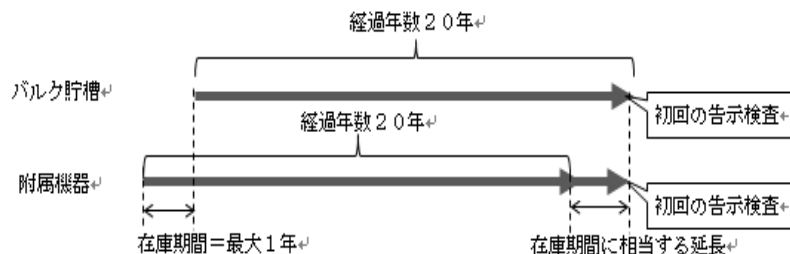
図 バルク貯槽と附属機器の告示検査期間のずれ
