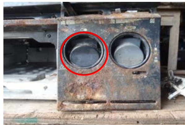
<物的損害> ガスコンロの左側つまみ部分の一部を焼損
